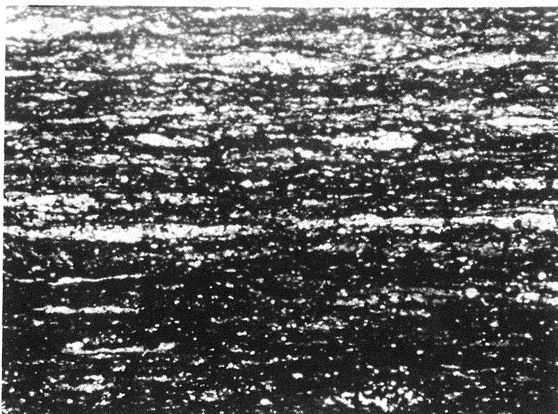
Fig. 12. Margiel laminowany materiałem bitumicznym. Otwór wiert. Jany 1, głęb. 2176,3–2176,5 m, bez analizatora; pow. 36 ×
