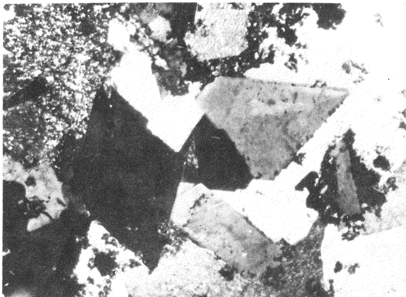
Fig. 15. Kryształy adularu o charakterystycznych romboidalnych przekrojach. Otwór wiertniczy WB-23, głęb. 324,5 m, nikole skrzyżowane; pow. 45 × Adular crystals with characteristic rhomboidal section. Borehole WB-23, depth 324.5 m, crossed nicols; × 45
