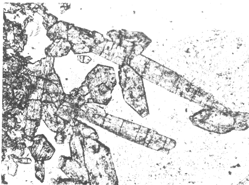
Fig. 16. Słupki epidotu w żyłę kwarcowo-K-skaleniowo-chlorytowo-epidotowej. Otwór wiertniczy WB-112, głęb. 443,5 m, bez analizatora; pow. 100 × Epidote pillars in quartz-potassium feldspar-chlorite-epidote vein. Borehole WB-112, depth 443.5 m, no analyser; × 100
