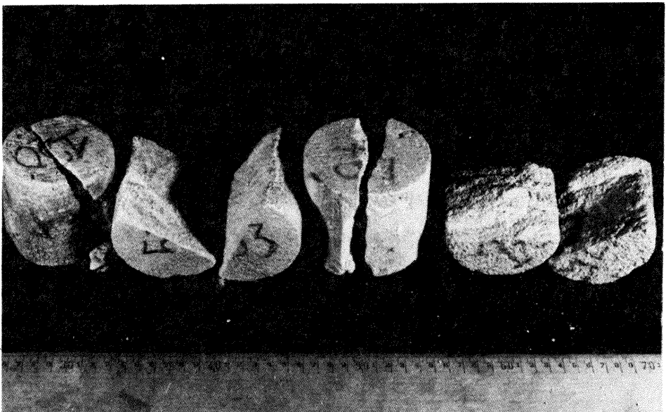
Fig. 4. Charakter zniszczenia próbek piaskowców podczas rozciągania. Fot. A. Nidek Destruction of sandstone samples during tension. Photo A. Nidek
