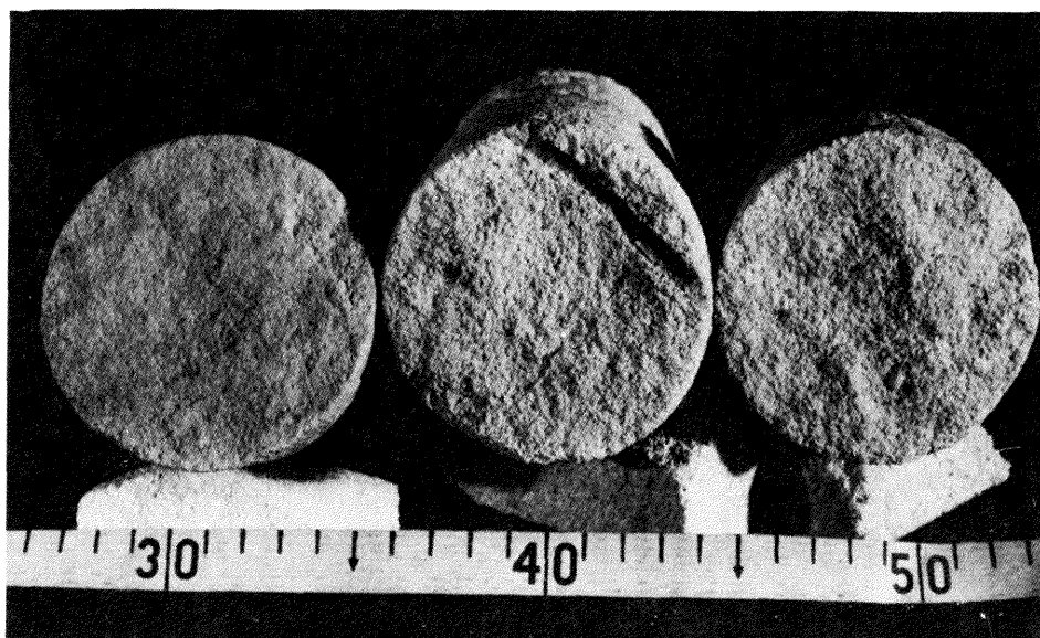
Fig. 7. Charakter powierzchni próbek piaskowców po badaniu zginania. Fot. A. Niedek Surface of sandstone samples after studies of bending. Photo A. Niedek
