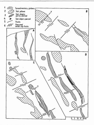
Fig. 2. Examples of horizontal displacements Przykłady przemieszczeń poziomych
