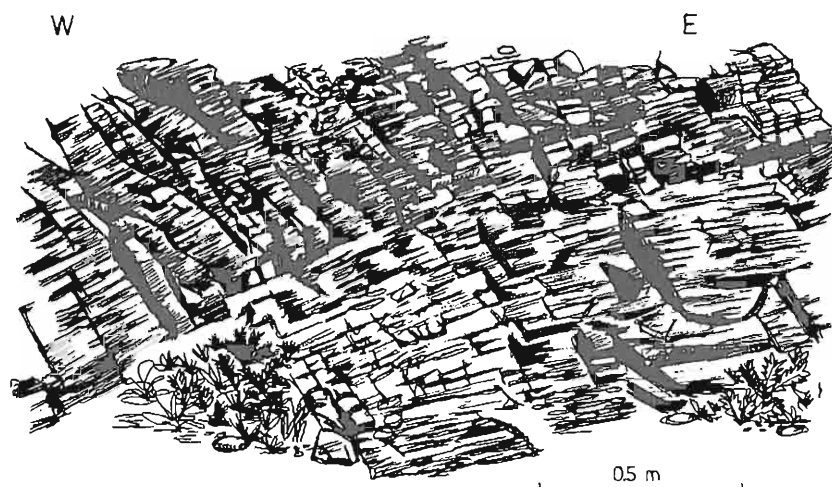
Fig. 8. Shear cleavage in the Middle Cambrian sandstones at Beradz Kliważ ścięciowy w środkowokambryjskich piaskowcach w Beradzu
