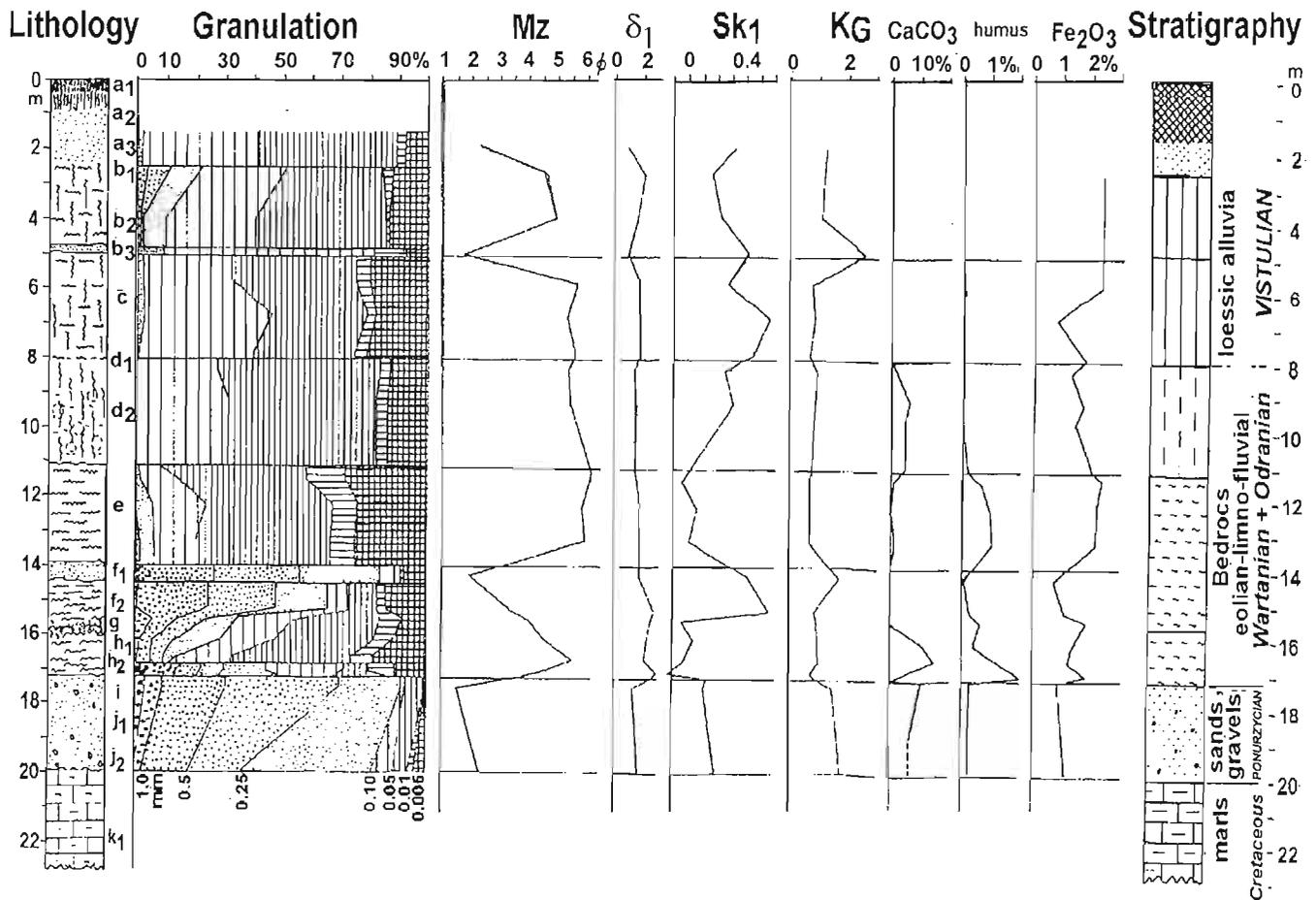
Fig. 9. Section Kolonia Horodło
