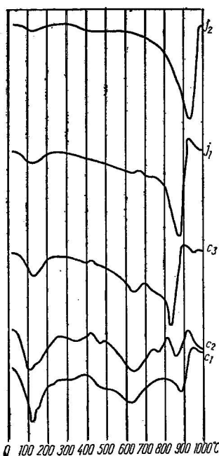
Fig. 2. Krzywe termicznych analiz różnicowych bentonitów z poszczególnych warstwek Curves of thermal differential analyses of bentonites from the individual laminae
